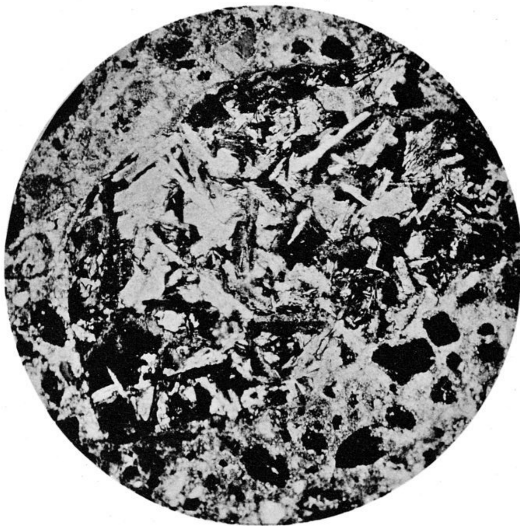
Fig. 30. Schieferfragment im konglomeratischen Kalksandstein (157). + Nicols. Vergr. 16:1. Fig. 31. Fragmente von vulkanischem Gesteine in Probe 157. + Nicols. Vergr. 60:1. Fig. 32. Doleritfragment in Probe 157. + Nicols. Vergr. 60:1.
