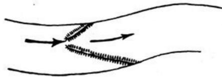
Fig. 72. Damm-Anlage zur Ueberwindung von Stromschnellen.
